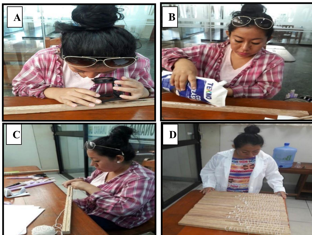
Figura 07. Fase de Laboratorio: A) Observando los anillos de crecimiento. B) Encolando las muestras. C) Amarrando las muestras. D) Muestras listas para el proceso de lijado y pulido.
