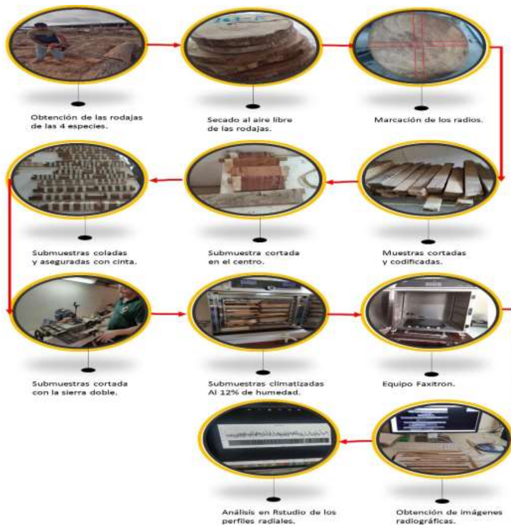
Figura 06. Flujograma de la secuencia de análisis para la determinación de la densidad aparente mediante densitometría de rayos X
