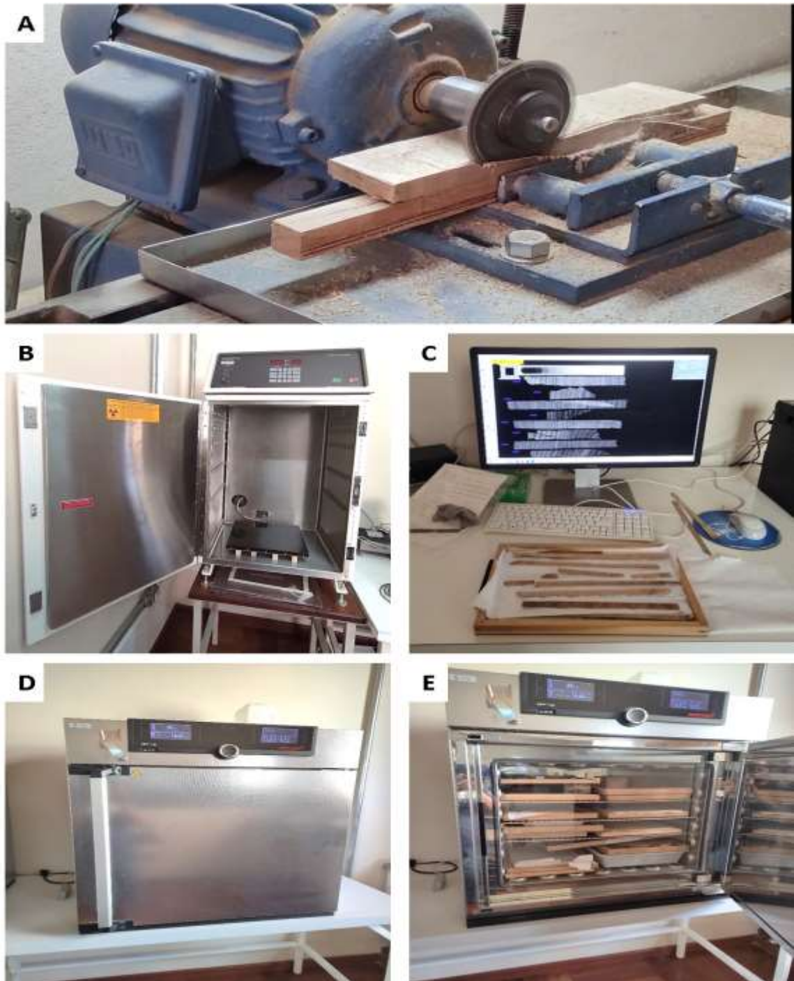
Figura 04. A) Sierra dupla cortando muestra de Jacaranda copaia . B) Vista general del equipo de rayos X Faxitron. C) Computadora con imágenes de rayos X de las maderas y muestras en la parte inferior. D) Climatizador al 12% de humedad. E) Disposición de las muestras en la cámara climática.
