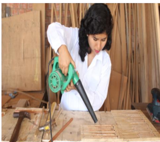
Figura 10. Utilizando soplete para evitar obstrucción de los poros.
