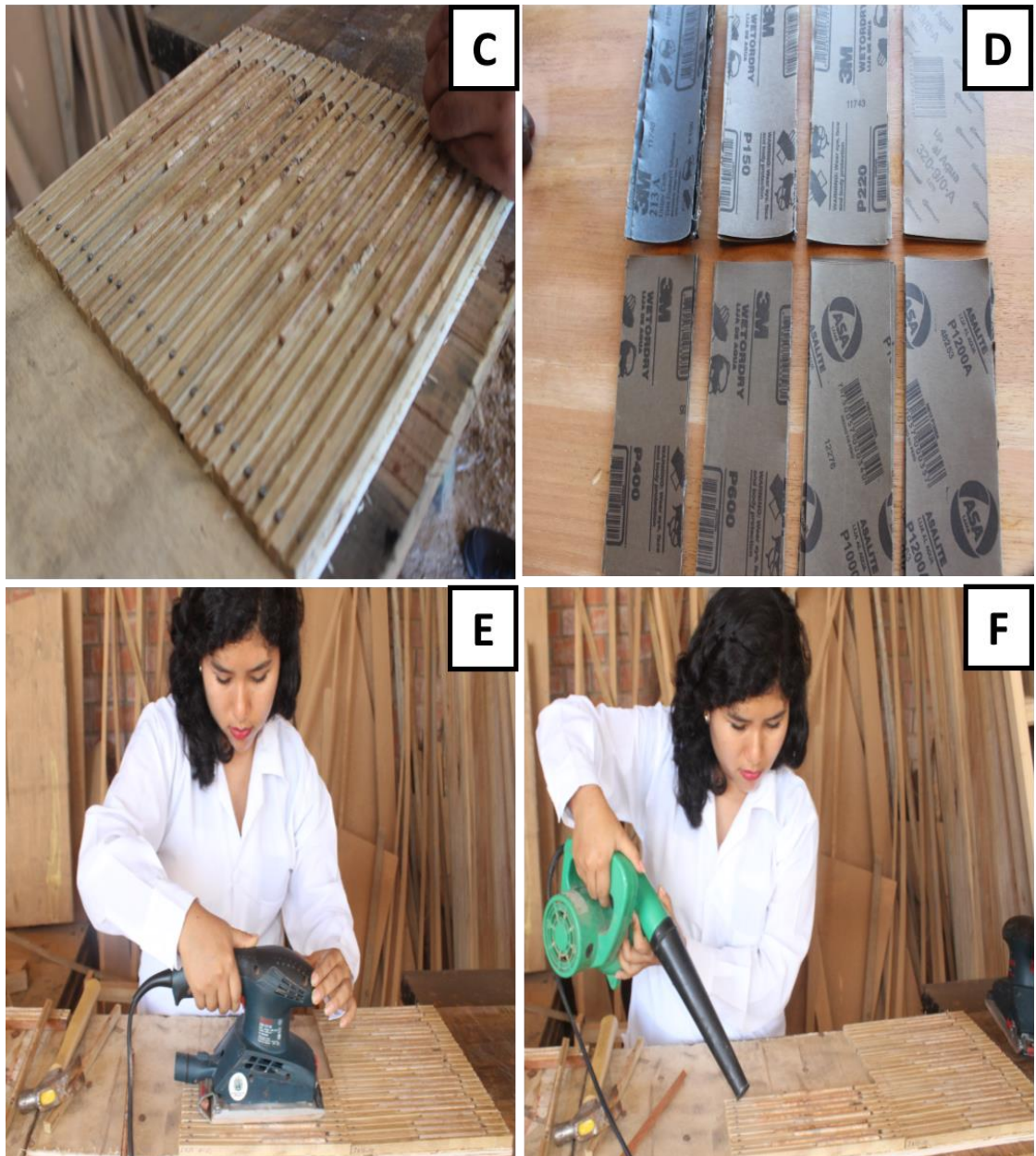
Figura 07. (C) Clavado de muestras en una tabla. (D) Lijas de diferentes granulaciones (80-1 200). (E) Proceso de lijado de muestras. (F) Uso de soplete para limpiar restos de lijado.
