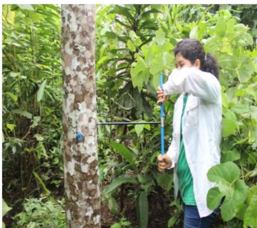
Figura 03. Extracción de muestras radiales
