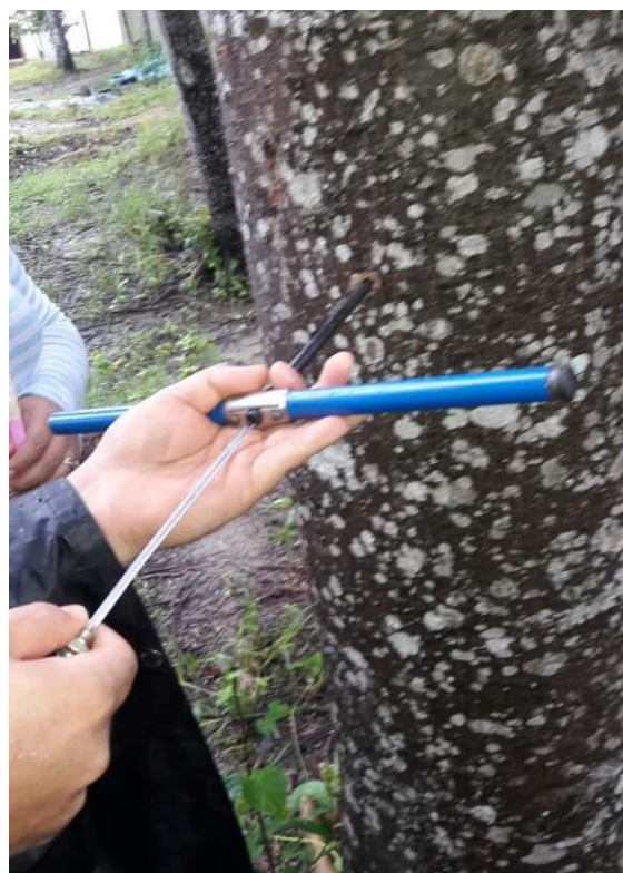
Imagen 6: Extracción de las muestras con el Barreno.
