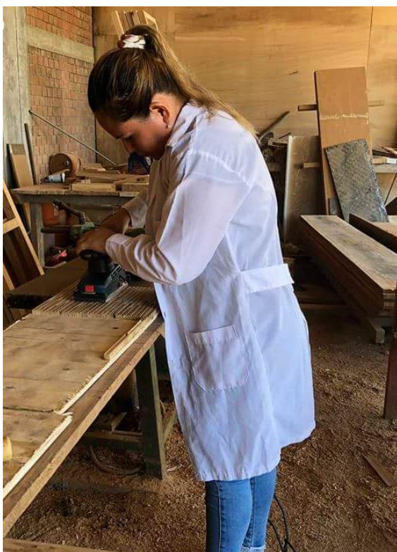
Imagen 19: Inicio del proceso de lijado de las muestras de Pashaco.
