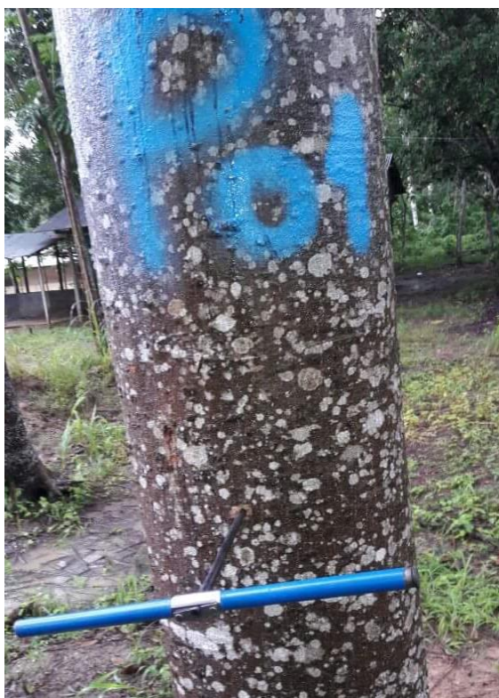
Imagen 5: Barreno de incremento en el fuste del pashaco.
