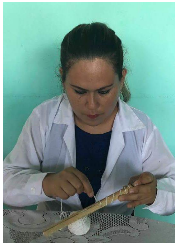
Imagen 12: Asegurando las muestras para que la presión sea constante durante el secado.
