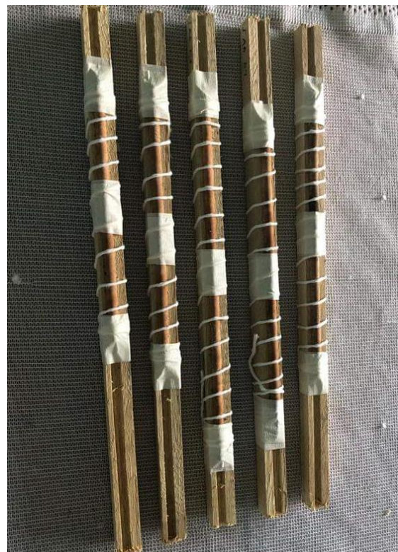
Imagen 16: Algunas muestras en proceso de secado de la cola.
