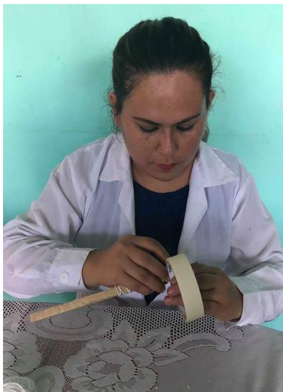
Imagen 13: Reforzando los extremos de las muestras dispuestos en el soporte de madera.
