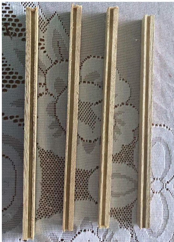
Imagen 9: Soporte de madera en donde serán acondicionadas las muestras de pashaco.
