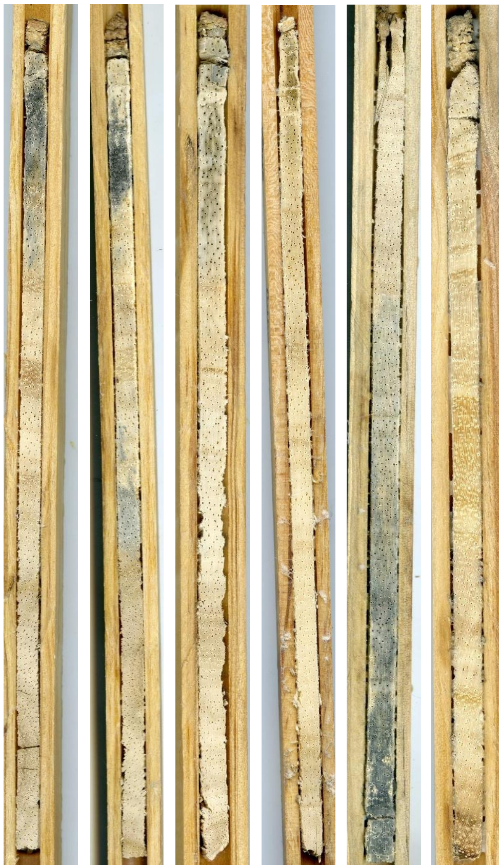
Imagen 21: probetas de madera en los soportes lijadas y pulidas de Pashaco Blanco.
