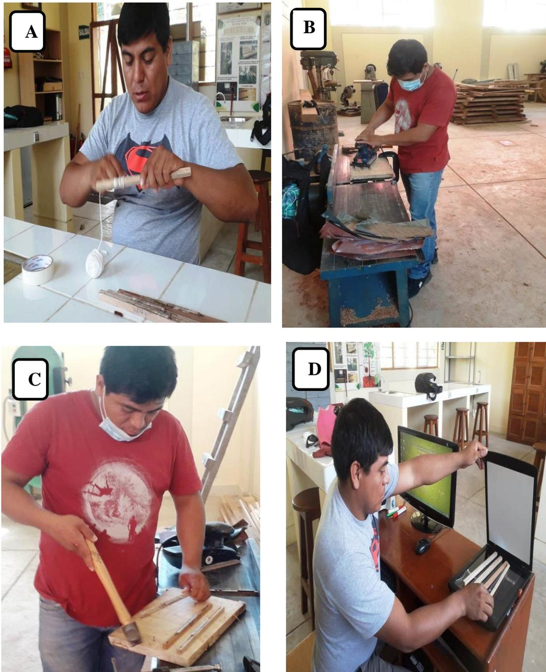
**Figura 07. A)** Sujetando la muestra al soporte. **B)** Lijando y puliendo las muestras. **C)** Extrayendo las muestras pulidas. **D)** Escaneando las muestras.
