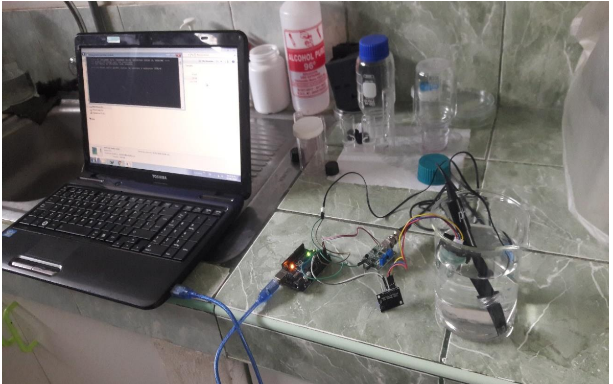
Foto 13: Captura de datos con el software, de los parámetros Ph, Conductividad, Temperatura y Turbiedad
