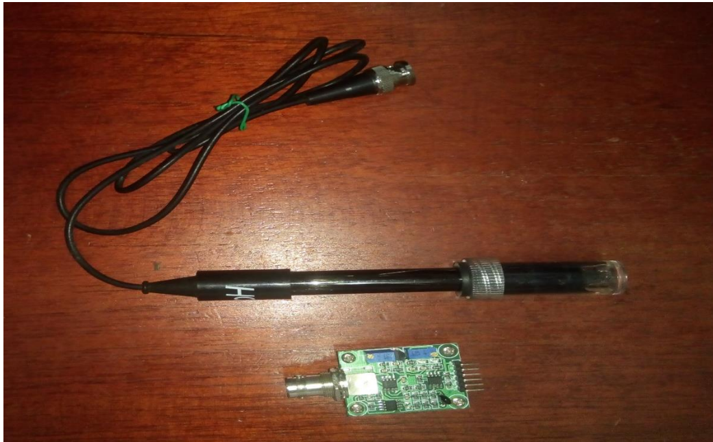
Figura 18: Sensor de Ph Fuente: Elaboración propia
