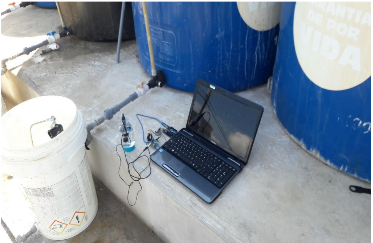
Foto 8: Prueba del prototipo, análisis de los parámetros: Ph, Conductividad, Turbiedad y Temperatura
