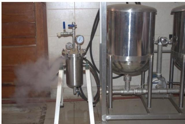
Figura 4. Autoclave Vertical de acero Inoxidable
