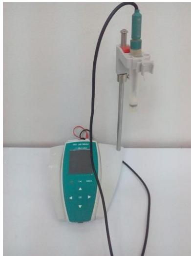
*Figura 9.* Potenciómetro digital de mesa
