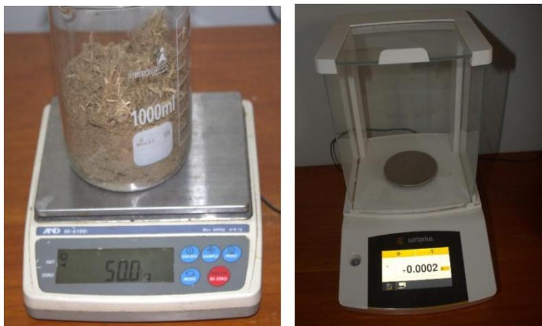
Figura 3. Balanza de precisión y balanza analítica
