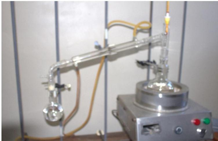
Figura 6. Equipo completo de destilación de alcoholes
