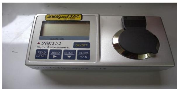
Figura 7. Refractómetro Digital
