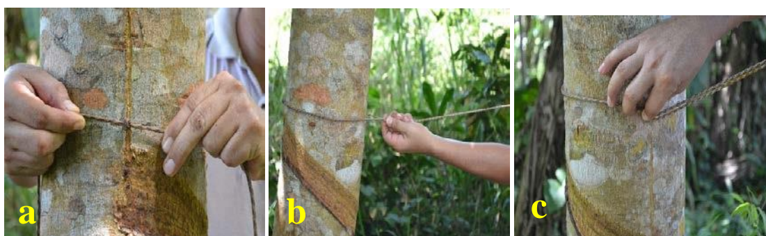
Figura 9. Compartimiento de tronco; (a) Primera línea vertical, (b) Unión de cordel desde los extremos para dividir el tronco, (c) Rayado de la segunda línea vertical.
