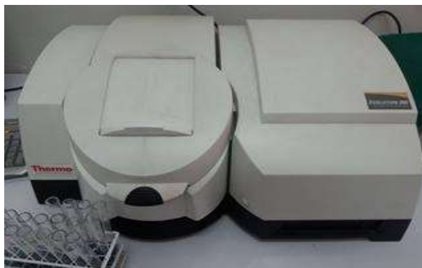
Fotografía 8: Espectrofotómetro, marca Thermo Scientific, modelo Evolution ® 600
