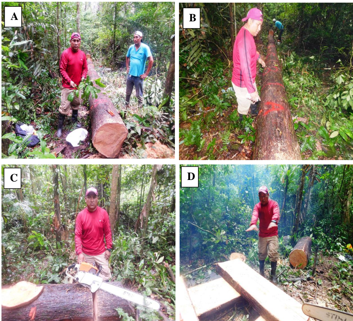
Figura 4: Fase de Campo: A) Muestra botánica de Cariniana decandra Ducke. B) Marcación de las trozas para la selección al azar. C) Obtención de trozas y D) Aserrado del tablón central.
