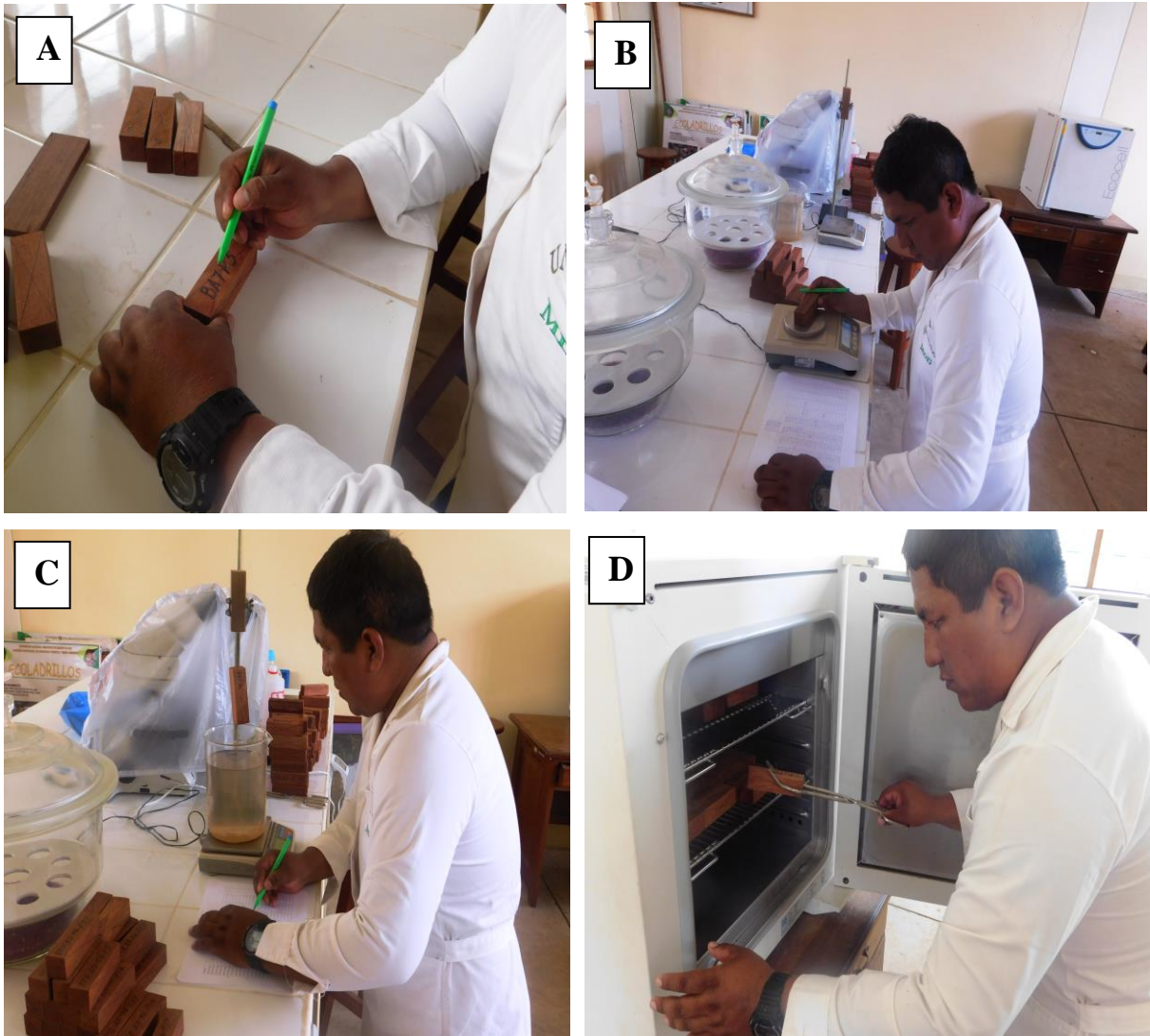
Figura 6: Fase de Laboratorio: A) Codificación de las probetas de Cariniana decandra Ducke. B) Obtención del peso inicial. C) Obtención del volumen r el método de inmersión y D) Secado en estufa de las probetas.
