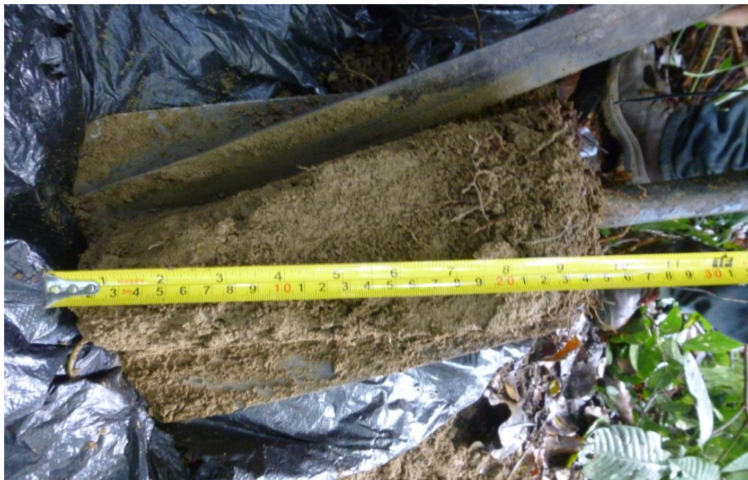
Foto 12. Extracción de 01 kgr de la submuestra de suelo de forma vertical con respecto a la profundidad de la calicata, el cual fue trasladado hacia el campamento de la concesión a fin de poder homogenizarse y posterior disposición al laboratorio.
