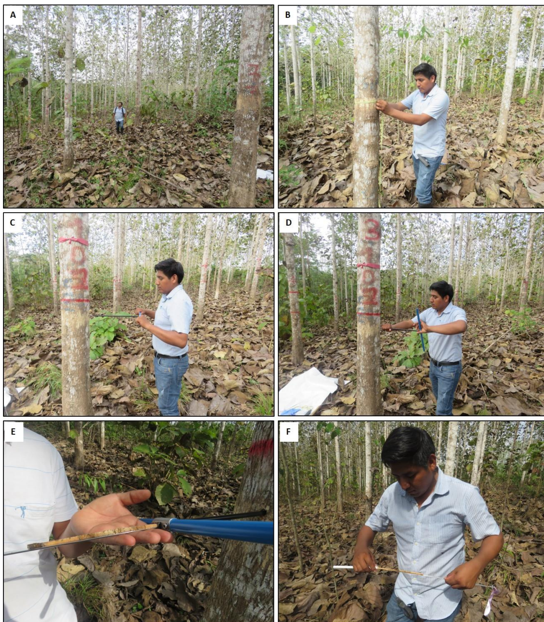
Figura 5. (A) Plantación de Tectona grandis . (B) Limpieza y Medición de circunferencia del árbol. (C) Posición para la extracción de bagueta radial con el barreno de Pressler. (D) El barreno se inserta en el árbol a la altura del dap, girando para penetrar hasta la médula. (E) Se extrae la muestra radial. (F) La muestra radial se coloca en una cañita plastica para su conservación. Fuente: Elaboracion propia.
