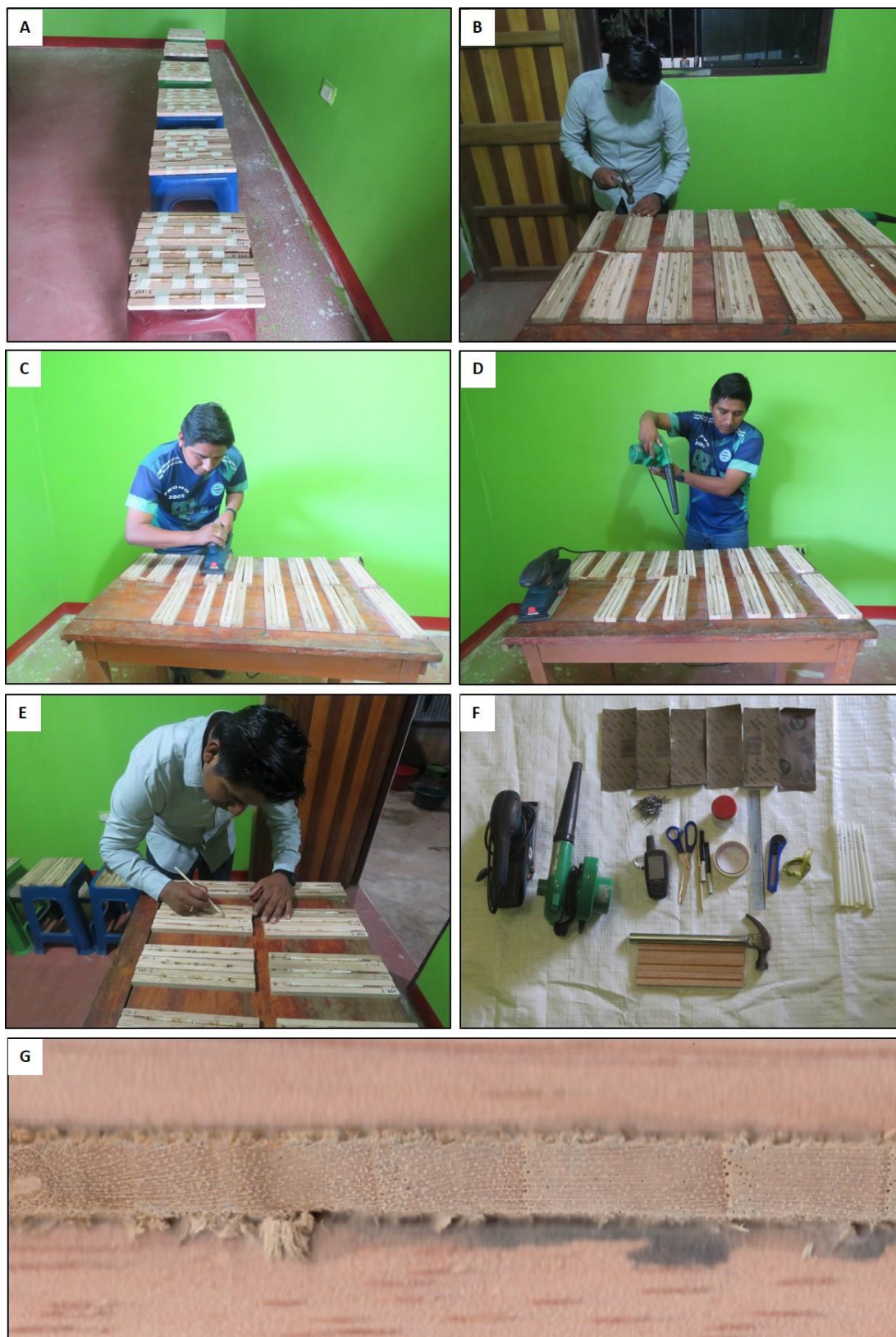
Figura 6. (A) Selección y agrupación de muestras. (B) Fijación de muestras en soportes. (C) Proceso de lijado. (D) Limpieza de muestras. (E) Demarcación del límite de los anillos de crecimiento. (F) Materiales utilizados. (G) Escaneo de muestras. Fuente: Elaboración propia.
